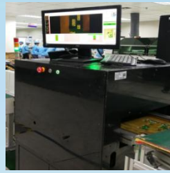
4.炉后焊接 AOI 检测
